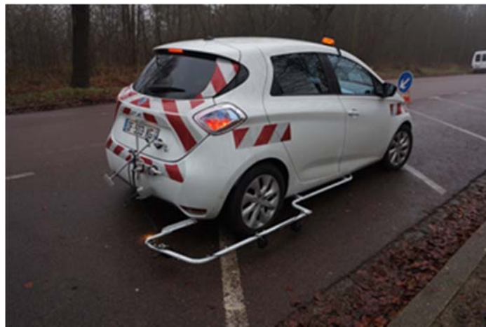
Photo 2 - Dispositif de mesure en continu (CPX) ; moyens de mesure de la Ville de Paris
