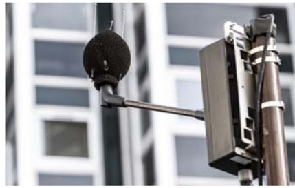
Photo 1 - Installation de microphone pour mesure de bruit rue Frémicourt
